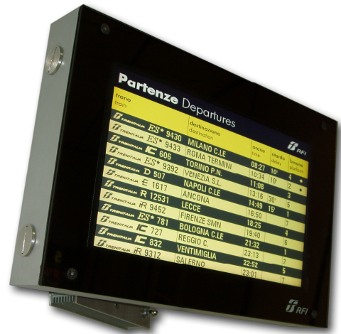
Monitor riepilogativo A/P a LCD-TFT mod. TF05-00 (Vista frontale)
